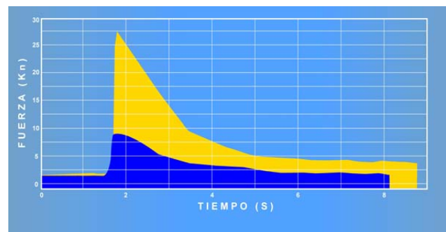
Comparación ensayo dinámico de caída con X-50 y sin absorbedor
